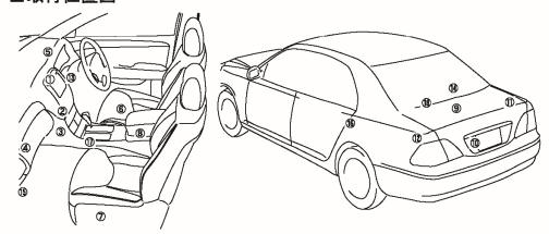
①TVモニター(本体)裏側 ②オーディオユニット裏側 ③オーディオユニット下側臭 ④グローブボックス奥 ⑤メーターパネル奥 ⑥運転席シート下側 ⑦助手席シート下側 ①刷テ席シート ト別 ⑧センターコンソール下側 ⑨トランクルーム中央上側 ⑩トランクルーム中央下側 ⑪トランクルーム右側 ⑰トランクルーム左側 心潭転底前侧 (1) 運転度後側 ⑤グローブボックス下側 16後部座席左側 ①ATリンケージ下側 ®リアアームレスト内
